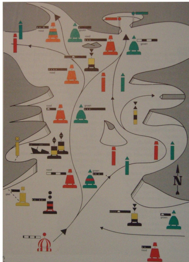
Schema soorten boeien (uit: Kustnavigatie Hollandia , 1997)
