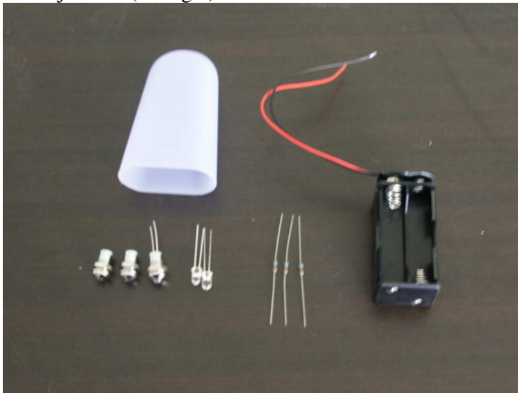
Fig. 1. Onderdelen om zelf een rondschijnend licht te maken.
