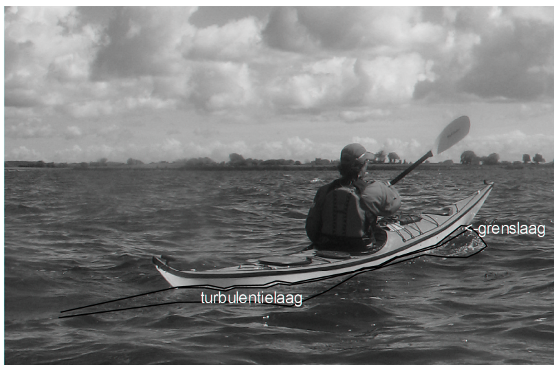
Fig. 6. De dunne grenslaag en de brede turbulentielaag langs de kano
